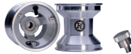
Felge 120mm mit Lagern 17mm verschraubt
